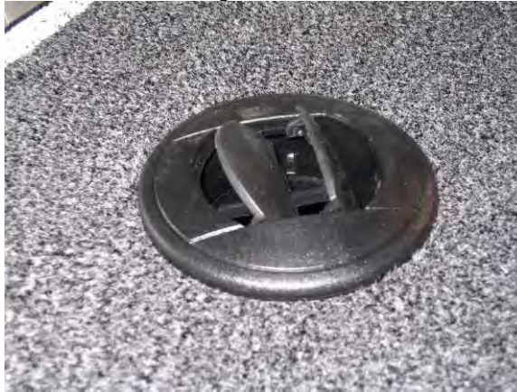
Buses de dégivrage
