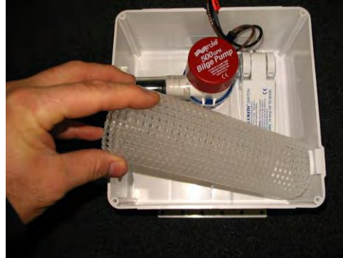
Retirez le tamis filtrant.
