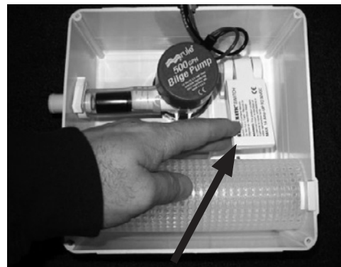
Déclenchement du flotteur
